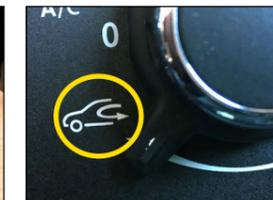
Com o veículo ligado, coloque o sistema de ar condicionado na função de recirculação.
