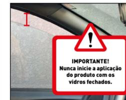
Deixe todos os vidros com uma abertura entre 5 a 10 centímetros.
